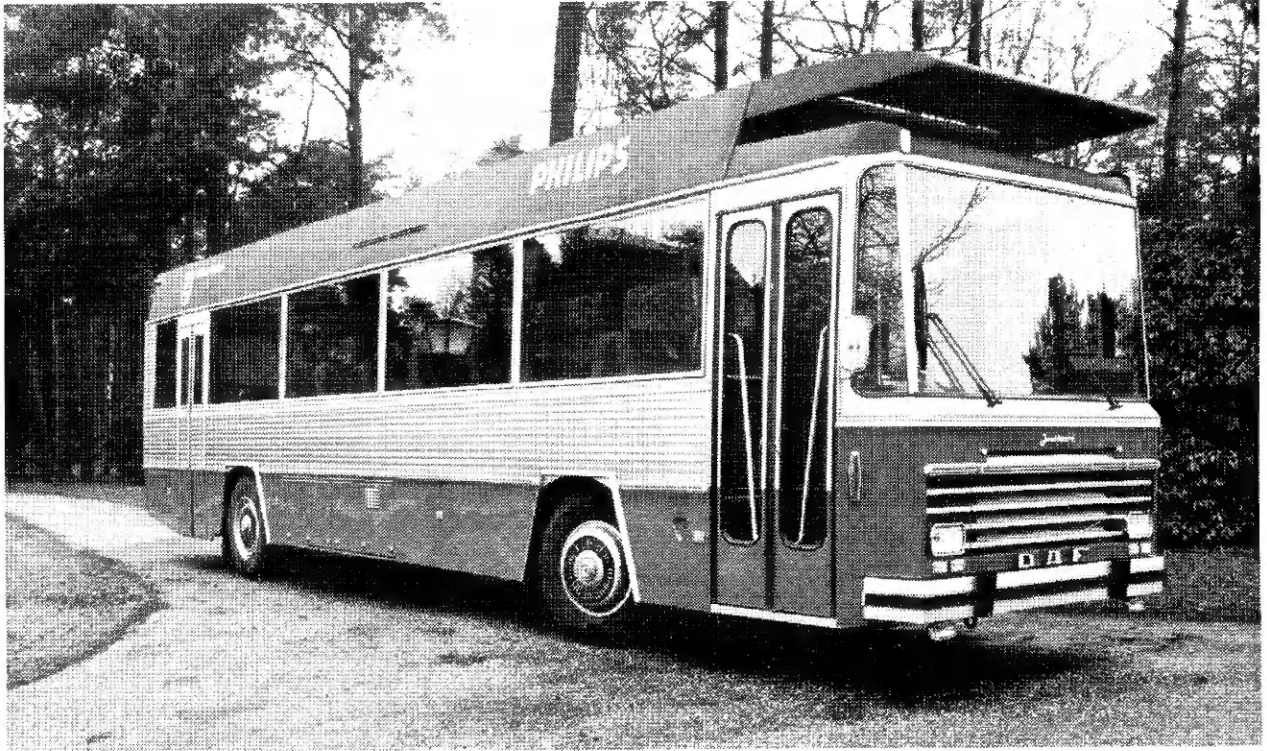
Afb. 1. De experimentele autobus met de Philips stirlingmotor.
